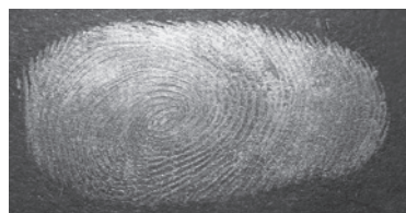
Fig. 5. Bild (mit schwarzem Hintergrund) eines auf einem Objektträger mit Sekundenkleber nachgewiesenen Fingerabdrucks.
