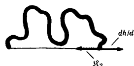
Abb.4. Ein Fadenmolekül, dessen Enden mit einer Geschwindigkeit \frac{dh}{dt} relativ zueinander bewegt werden, setzt dieser Änderung auf Grund der Formviskosität eine der Änderungsgeschwindigkeit \frac{dh}{dt} proportionale Kraft \mathfrak{R}_2 entgegen
