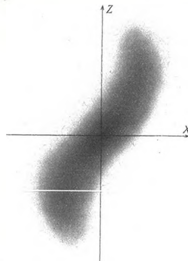
Abb. 8. Verteilung der Fadenendpunkte in strömender Lösung für Moleküle mit großer innerer Viskosität. Die Anfangspunkte der sämtlichen pro Kubikzentimeter vorhandenen Fadenmoleküle denken wir uns in den Nullpunkt des Koordinatensystems gelegt; die Strömungsrichtung fällt mit der z-Achse zusammen, die Richtung des Strömungsgefälles mit der x-Achse. Moleküle, deren h -Wert groß ist, werden in der strömenden Flüssigkeit besonders gut orientiert
