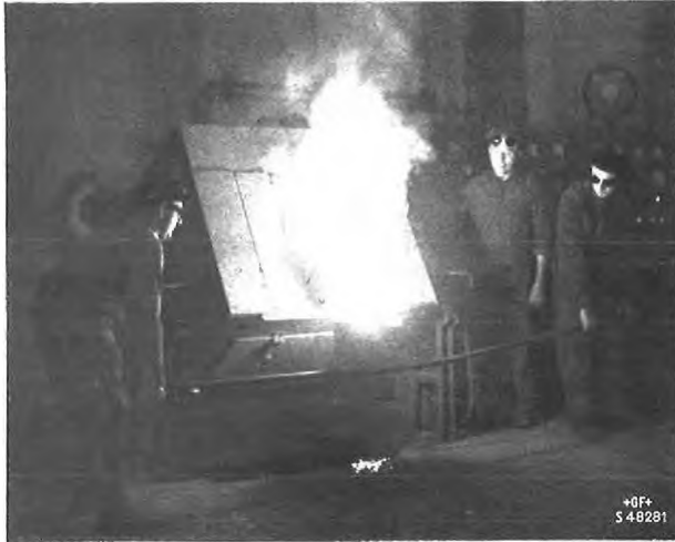
Abb. 2. Abfassen des flüssigen Stahles am Hochfrequenzofen
