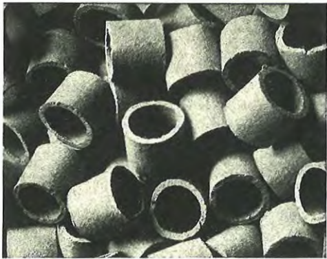
Abb. 10. Die lose geschichteten Füllkörper aus Steinzeug in den Steinzeigtürmen dienen der intensiven Durchmischung von Gasen und Flüssigkeiten
