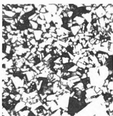
Abb. 9. Mikrostruktur eines Hartmetalles. Die einzelnen Carbidkörner (weiß) sind mit Bindemetall (dunkel) lückenlos verkitet. Sintermetall. 1500fach vergrößert
