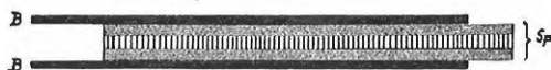
Abb. 3. Darstellung des Querschnitts einer Panzerholzplatte. Sp bedeutet die Sperrholzplatte, B die beiden aufgeleimten metallischen Bleche
