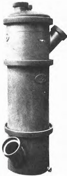
Abb. 9. Die Steinzeigtürme werden aus mehreren Teilen zusammengesetzt
