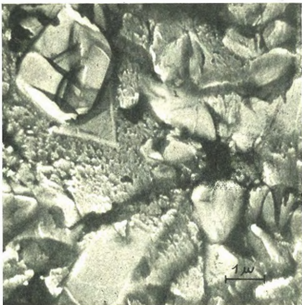
Abb. 10. Umwandlung von CuCl-Kristallen in basisches Chlorid
