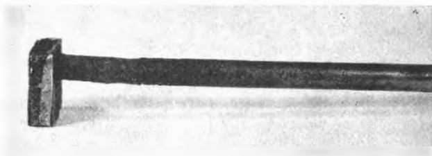
Fig. 9. Corrosion par fatigue d'une tige actionnant le tiroir d'une pompe à vide. Acier ordinaire. La corrosion est visible sur la gauche de la tige où s'exerce le plus grand effort mécanique
