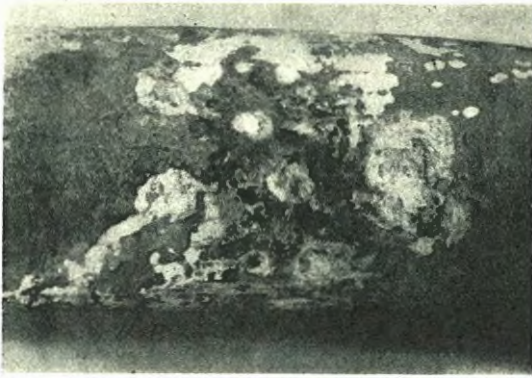
Fig. 3. Corrosion électrochimique. Tube d'aluminium percé à l'endroit où il était en contact avec une bride en fer. Agent corrosif : eau
