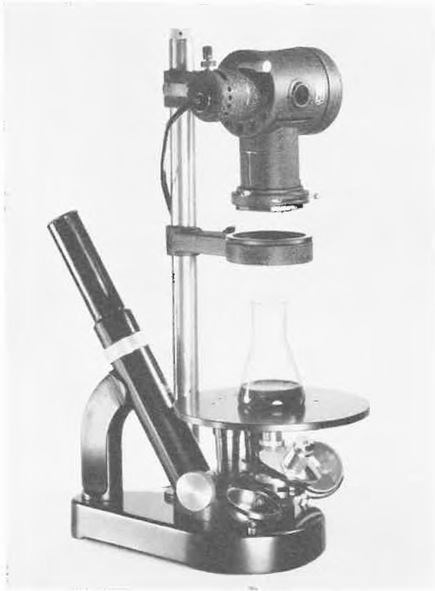
Abb. 1. Chemiker-Mikroskop nach WALDMANN, monokular, mit Beleuchtung und Polarisationsfilter (E. Leitz, Wetzlar)
