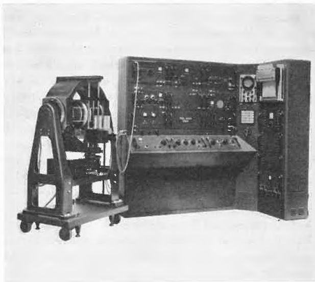
Abb. 6. Kerninduktionsspektrometer der Firma Trüb, Täuber, Zürich
