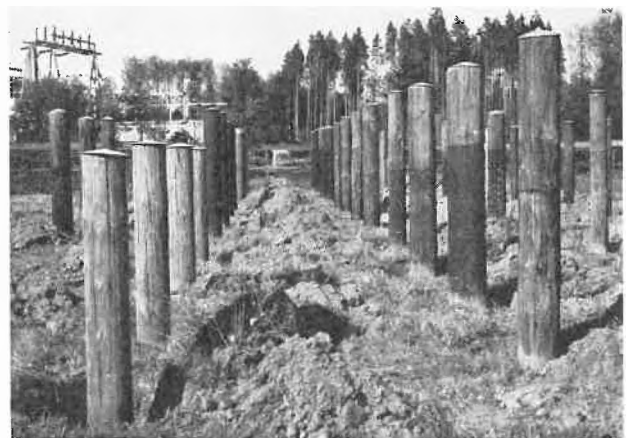
Abb. 9. Teilansicht eines Versuchsfeldes des VSE zur Prüfung von Stangenimprägnierungen in Rathausen bei Emmenbrücke (Aufnahme: CKW, Luzern)
