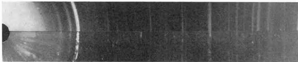
Abb. 2. Zusammengesetzte Debye-Scherrer-Aufnahme (natürliche Größe) Untere Hälfte: Prandtl-Kristalle. Obere Hälfte: Quarzpulver als Vergleichssubstanz
