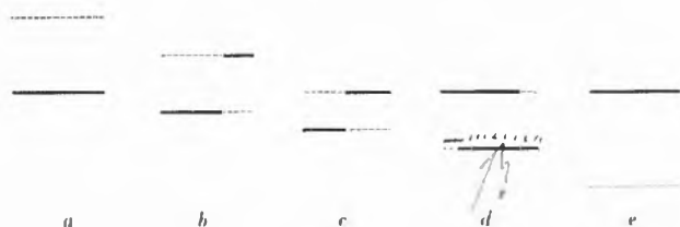
Abb. 5. Energieniveaus innermolekular-ionoider Farbstoffe. Zunahme des polaren Charakters von a nach e. c: Zustand größter Mesomerie (Cyanin). ····· Anteil der polaren, — Anteil der unpolaren Formel an den Überlagerungszuständen. Unten Grundzustand, oben Anregungszustand
