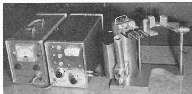
Abb. 8. Gesamtansicht der Apparatur zur thermoelektrischen Molekulargewichtsbestimmung
