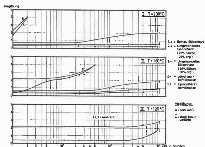
Abb. 7. Vergilbungsneigung von Lackfilmen in Abhängigkeit von Temperatur und Zeit
