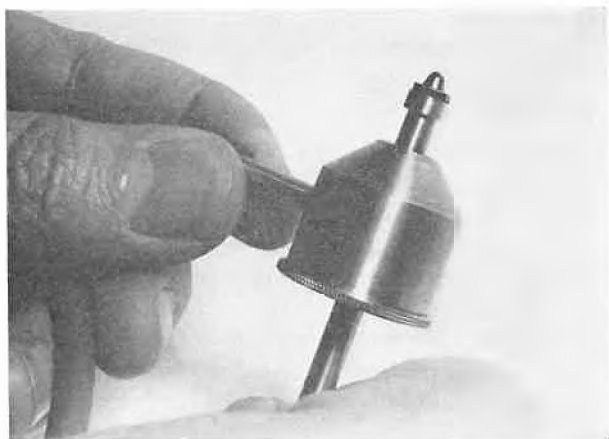
Abb. 4. Modifizierter Stallwood-Jet mit eingeführtem Preßlinghalter und Preßling
