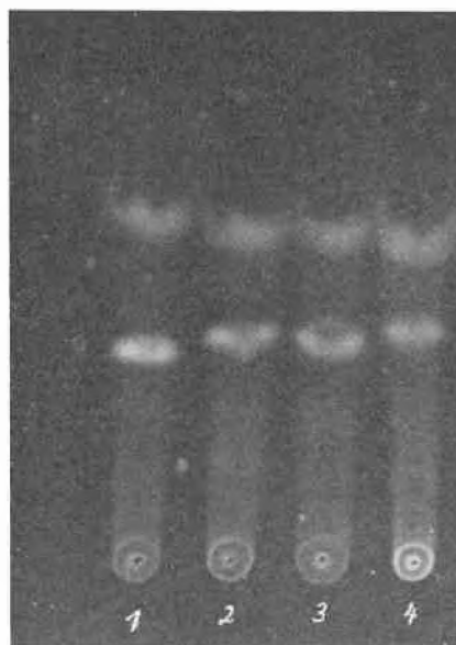
Abb. 17. Dünnschichtchromatogramm. Chromatographische Gegenüberstellung der roten inkriminierten und Vergleichssplitter. 1 Roter Lack aus den Bearbeitungsrückständen vom Tatort. 2 Roter Lack aus einer Woldecke, die im PW eines Verdächtigten vorgefunden wurde. 3 Roter Lack aus herausgeschnittenem Eisenblechteil des Kassenschrankes. 4 Roter Lack (zum Vergleich) ab Griff der Rohrzanze aus dem Rhein
