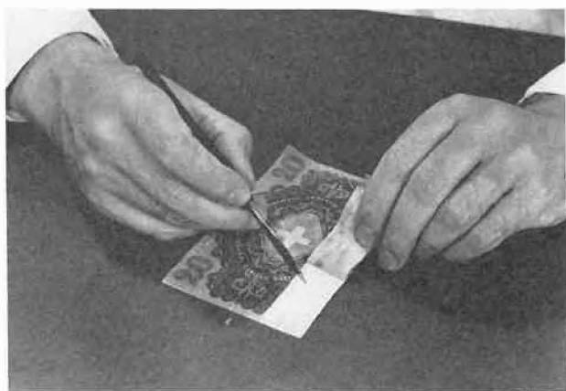
Abb. 6. Partielles Abziehen der mit Druckfarbe behandelten obersten Papierschicht
