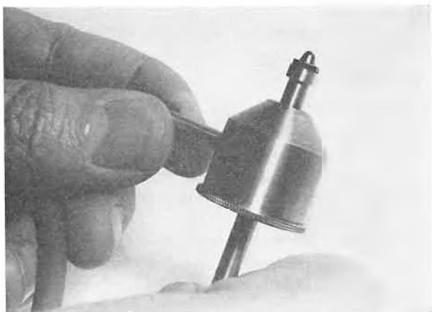
Abb. 4. Modifizierter Stallwood-Jet mit eingeführtem Preßlinghalter und Preßling
