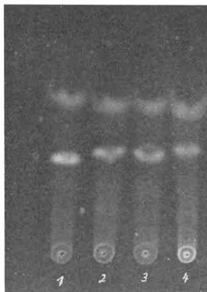
Abb. 17. Dünnschichtchromatogramm. Chromatographische Gegenüberstellung der roten inkriminierten und Vergleichssplitter. 1 Roter Lack aus den Bearbeitungsrückständen vom Tatort. 2 Roter Lack aus einer Woldecke, die im PW eines Verdächtigten vorgefunden wurde. 3 Roter Lack aus herausgeschnittenem Eisenblechteil des Kassenschranke. 4 Roter Lack (zum Vergleich) ab Griff der Rohrzanze aus dem Rhein
