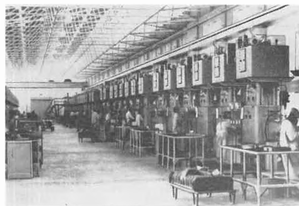
Abb. 16. Werkhalle der De Beers Johannesburg mit 75 Höchstdruck-aggregaten zur Herstellung synthetischer Diamanten (aus C. BALLHAUSEN, VDI-Z. 105 [1963] 617)
