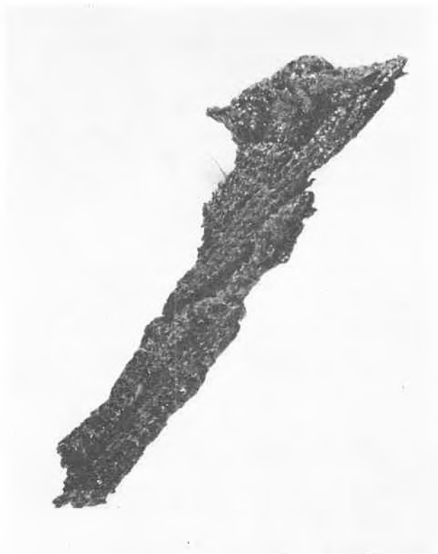
Abb. 3. Geschmolzener und wieder erstarrter Partikel mit noch feststellbarem Faserverlauf (Vergrößerung: etwa 5fach linear)
