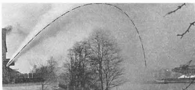
Abb. 2. Kesselabblasversuche mit Berstplatten
