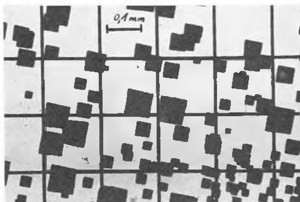
Fig. 1. Grains d'argent, développés chimiquement à la surface d'un macrocristal de AgBr d'orientation (100)
