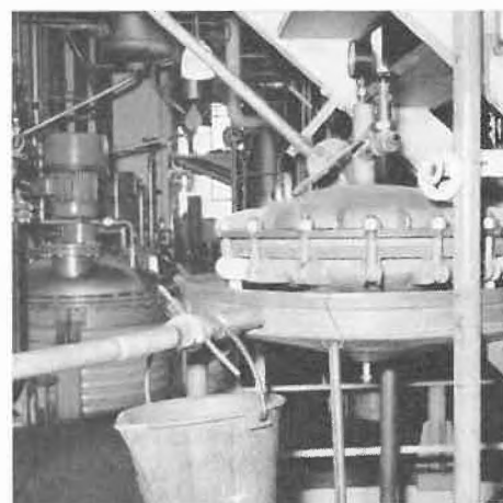
Abb. 10. Fangschale an einer Drucknutsche. Unterstellter Eimer an der Überwurfverbindung des Filtratrohres
