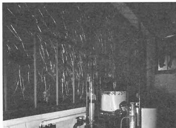
Abb. 1. Zertrümmerung eines Labors durch etwa 8 g explodierendes Ätherperoxid. Der Glaskolben mit der Ware befindet sich im 40-l-Emailbecken im Vordergrund. Beachte die Wiedergabe der Druckwelle an der linken Fensterfront
