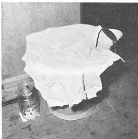
Abb. 12. So darf man nie Behälter mit flüchtigen Stoffen abdecken. Flüchtige, giftige und brennbare Prozeßstoffe gehören stets in geschlossene Behälter, die notfalls über Dach entlüftet sind oder über geeignete Sorptionsanlagen ins Freie münden
