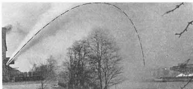
Abb. 2. Kesselabblasversuche mit Berstplatten
