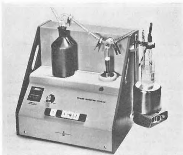
Abb. 1. Präzisionsimpulsbürette mit digitalem Antriebssystem durch Schrittmotor (Polymetron AG, Glattbrugg)
