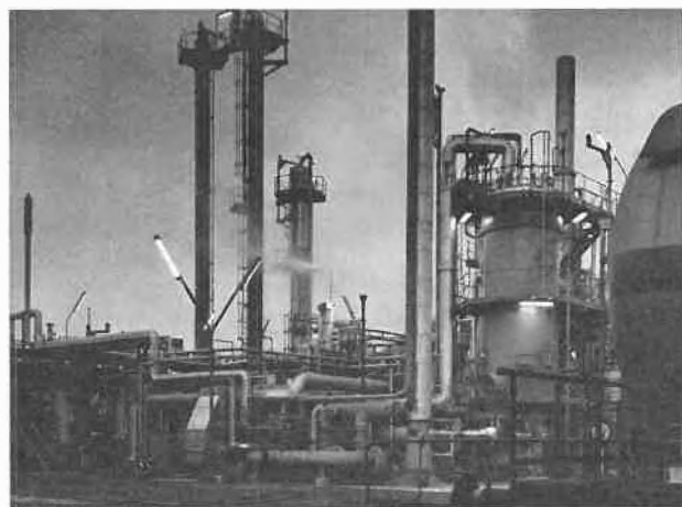
Abb. 34-7. Spaltanlage zur Erzeugung von Reinwasserstoff aus Benzin. Rechte Bildseite: Spaltofen, linke Bildseite: zweistufige \text{CO}_2 -Wäsche mit Stripper
