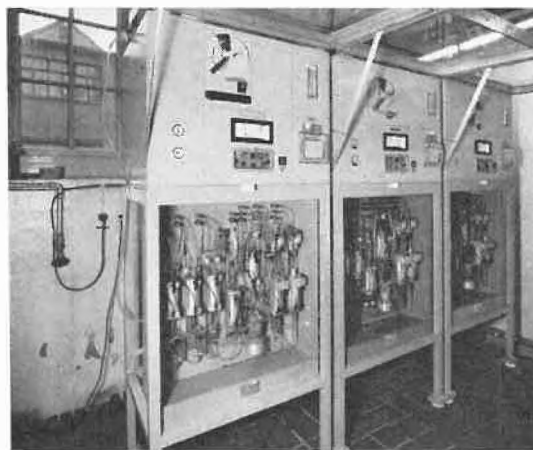
Abb. 11. Titrierautomaten für die Bestimmung von \text{H}_2\text{SO}_4 und \text{ZnSO}_4
