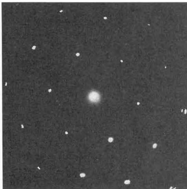
Abb. 2. Elektronenbeugungsdiagramm desselben Kristalls nach Rekristallisation im Elektronenstrahl
