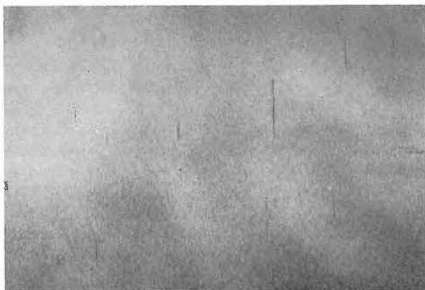
Abb. 4. Oxidische Einschlüsse in AlMg_3 -Blechen, nach der anodischen Oxidation sichtbar
