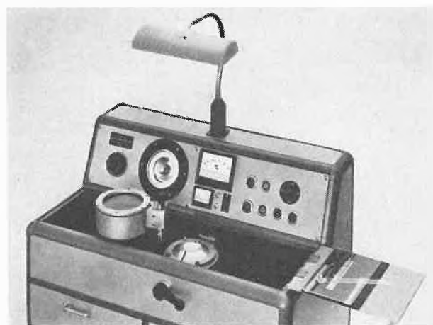
Abb. 3. Alu-Schmelztester der Firma Feinmechanik-Anstalt, Schaaf FL
