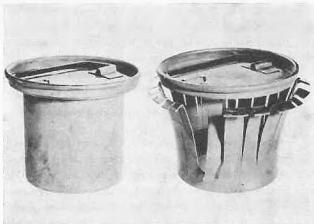
Abb. 10. Wirkung von Quicksilberlösung auf Messing mit inneren Spannungen. Näheres vgl. Text
