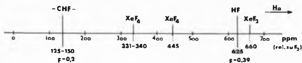
Abb. 4. Vergleich der chemischen Verschiebungen von ^{19}\text{F} in verschiedenen Verbindungen
