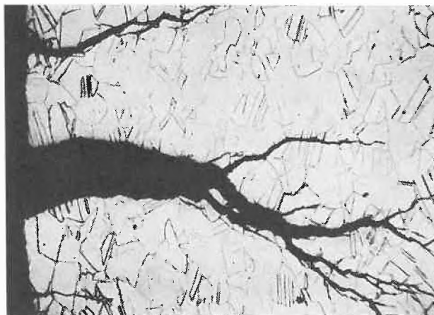
Abb.4. Transkristallin-verzweigte Risse in Messing Ms72, Riß durch Biegen geöffnet
