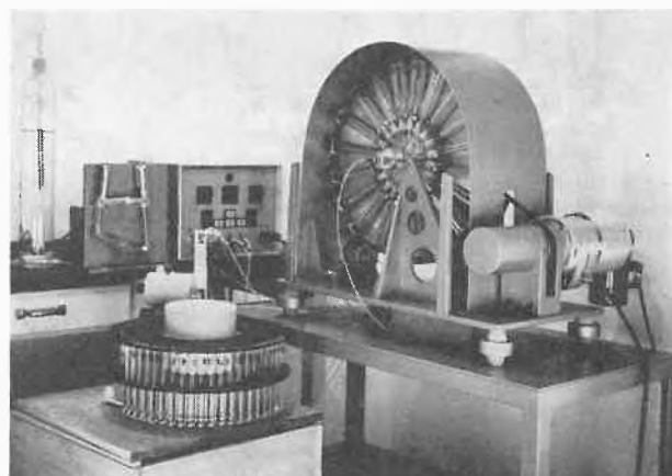
Abb. 10. Verteilenzentrifuge mit 40 Verteilgefäßen. Von links nach rechts Phasenvorrat, Pumpen, Steuergerät, davor Fraktionsensammler, Zentrifugenscheibe, Antrieb 26
