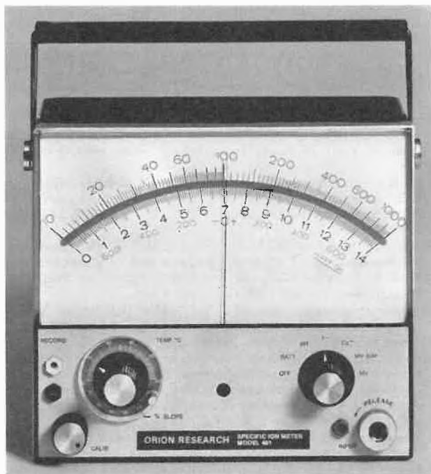
Abb. 1. Ionen-Meter Modell 401 zur direkt-potentiometrischen Konzentrationsbestimmung der Orion Research (Polymetron AG, Glattbrugg)
