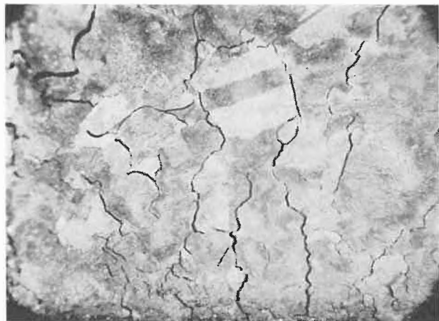
Abb. 7. Korngrenzenangriff an Blei durch essigsaurer Nitratlösung. Risse durch Biegen geöffnet. Man beachte die nicht angegriffenen Zwillingskorngrenzen
