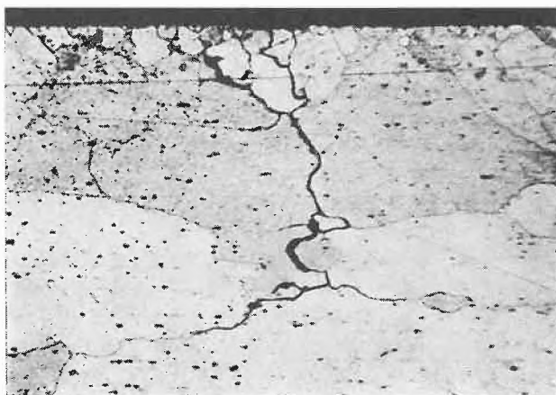
Abb.3. Interkristalline Rißbildung in einer AlZnMg1-Legierung
