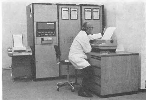
Abb. 3. Luftüberwachungssystem im Fricktal. Der Computer der zentralen Auswertstelle nimmt von den Außenstationen die Meßresultate auf und verarbeitet sie. Werden bestimmte Höchstwerte erreicht, löst er automatisch Alarm aus. Der Computer eicht auch regelmäßig die Monitoren. Photodienst Roche
