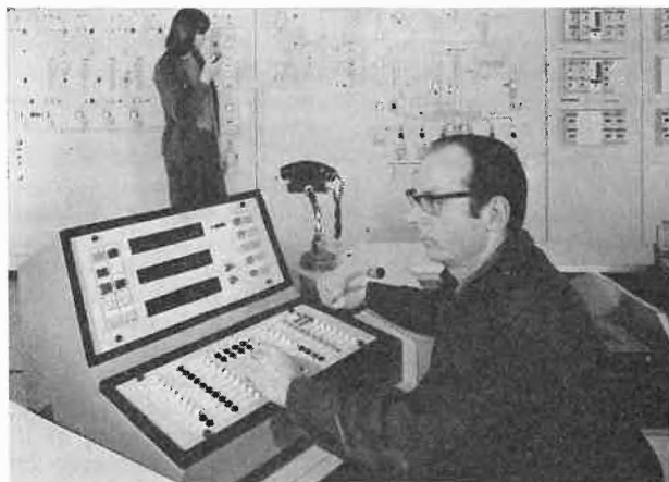
Abb. 3. Die Steuerung des Fabrikationsprozesses geschieht durch einen zentralen Prozeßrechner, der den ganzen Ablauf dauernd kontrolliert und steuert
