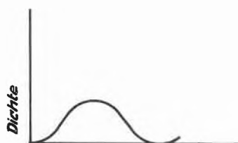
Abb. 2 b. Dichteverlauf in einem Kontaktraster (eindimensional)
