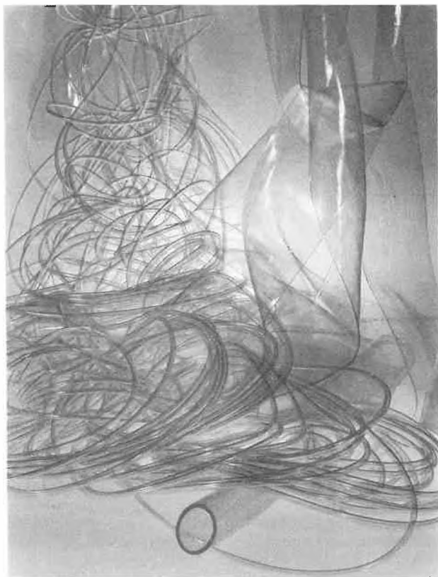
Abb. 1. Weich-PVC-Getränke- und Flachschräuche verschiedener Kaliber
