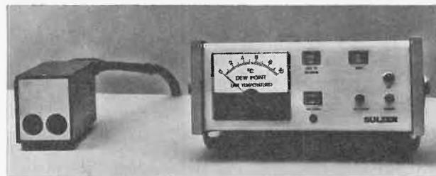
Taupunktmeßgerät zur raschen und präzisen Feuchtemessung. Dimensionen: Anzeigeteil 230×212×95 mm, Fühlerteil 66×160×76 mm
