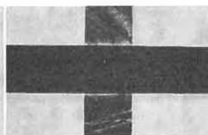
Fig. 2. Image développée sur un cristal de PbBr_2 . Exposition en présence d'oxygène: verticale, 1 s; horizontale, 10 s
