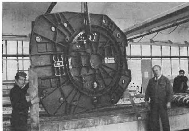
Abb. 1. Oxal-Hartanodisierung eines großen Gußstückes aus Anticordal-70 (G-AlSi7MgTi), Abmessungen 2600×2440×265 mm, Gewicht über 500 kg
