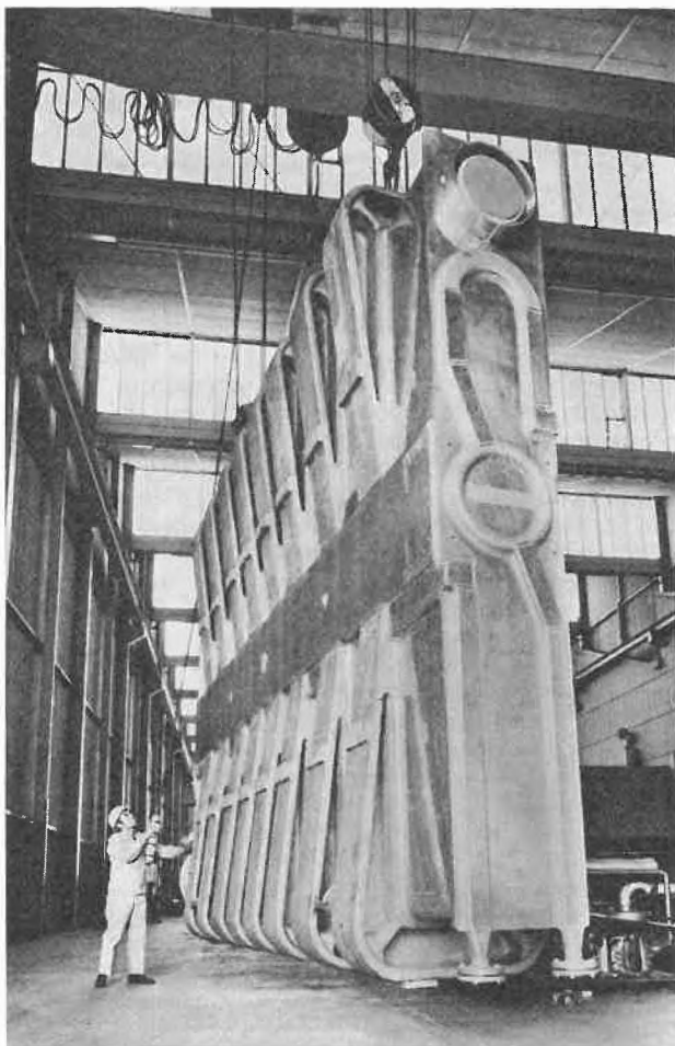
Abb. 5. Eine Hochfrequenzkavitat auf dem Prufstand. Diese machtigen Hohlraumresonatoren (sogenannte HF-Kavitaten) halten ein Hochvakuum von 10^{-4} Torr. Zur Versteifung gegen den Atmospharendruck sind sie mit Verstarkungsrippen ausgerustet, in welchen Kuhlwasserkanale zur Ableitung der Verlustwarme angebracht sind; siehe auch Frontseite (Photo: Aluminium-Schweiwerk AG, Schlieren)
