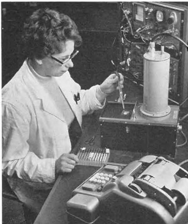
Spalten eines Lithiumfluorid-Kristalls. Die so gewonnene Scheibe dient als «Fenster», durch das sich die Wirkung radioaktiver Strahlung beobachten läßt. Der Kristall wurde von der Firma Rank Precision Industries, Brentford (Middlesex), entwickelt
