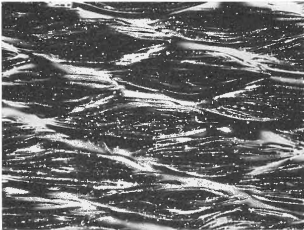
Abb. 3. Oligomere auf PES-Satin unter polarisiertem Licht, 75 × (Photo: Labor für Textilmikroskopie, CIBA-GEIGY AG)
