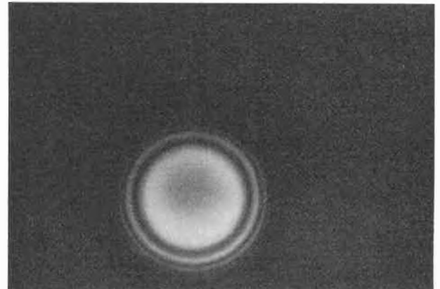
Abb. 5. Interferenzzonen in einem 1 s alten Siliconölfilm zwischen einer 0,3-µl-Luftblase und einer freien Oberfläche (Aufnahme mit einfallendem Wolframlicht)
