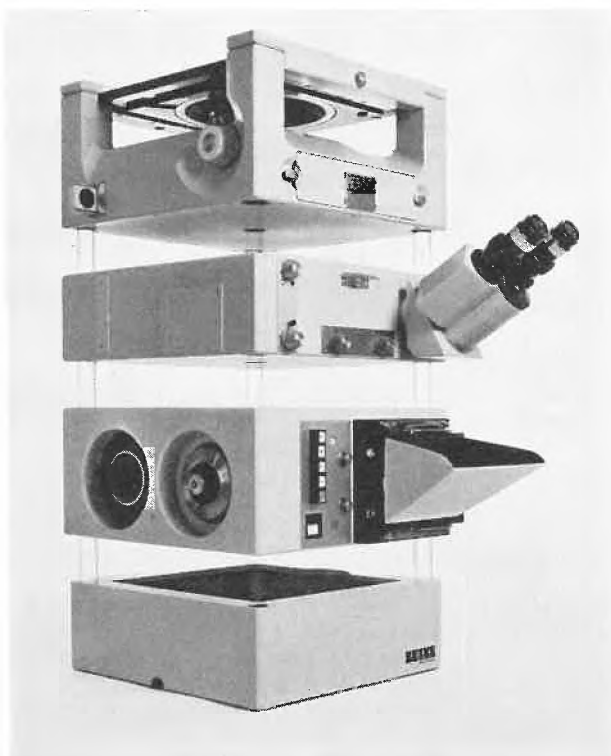
Konstruktionsprinzip des Zeiss Axiomat NDC (links), IAC (rechts). Die Hauptfunktionen des Mikroskops sind auf vier Bausteine verteilt. Von oben nach unten:
