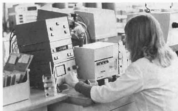
Abb. 1. Das Wägeresultat wird in der organischen Mikro-Elementaranalyse als elektrisches Signal an den Rechner übermittelt. Dieser verarbeitet das Wägeresultat zusammen mit den Daten des Analysenautomaten (Foto: Mettler Instrumente AG)
