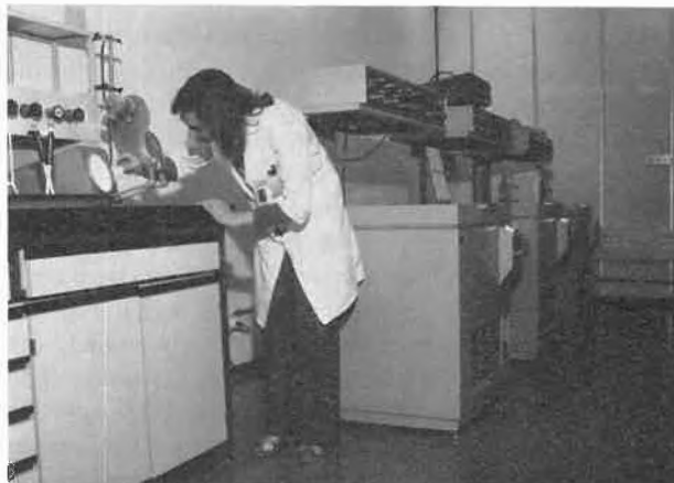
Abb. 1: Flüssigszintillator-Spektrometrie. Kontrolle der vollständigen Auflösung einer Messprobe mit polarisiertem Licht. Im Hintergrund 3 Spektrometer.
