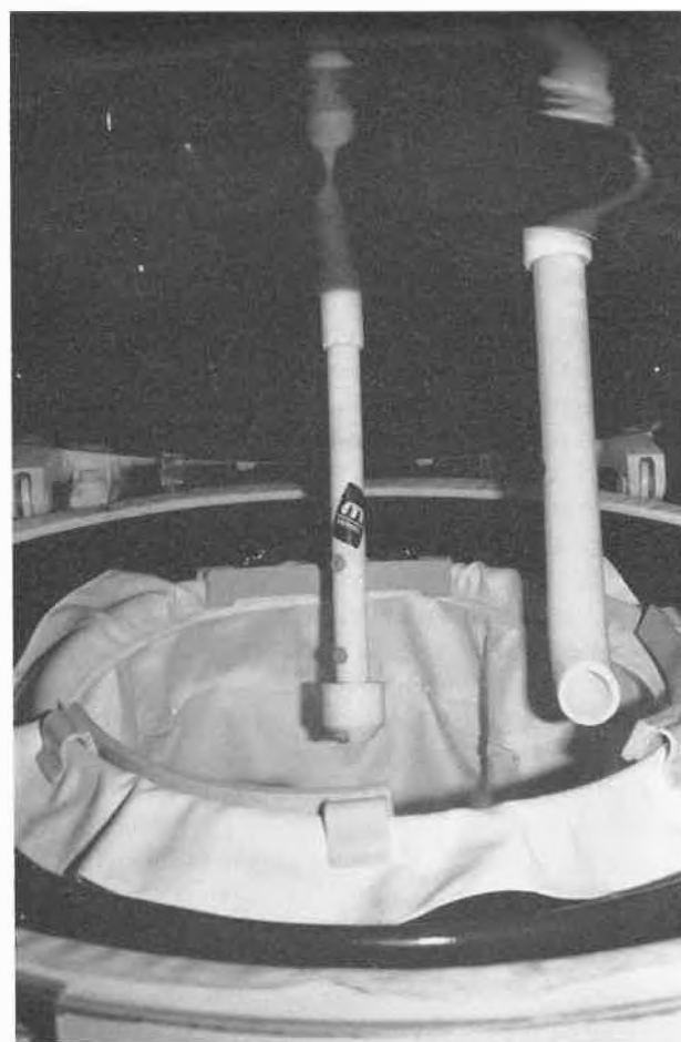
Abb. 4: Vollemaillierte Filterzentrifuge mit Füll- und Waschröhr aus Polytetrafluoräthen, Firma Pfaudler.
