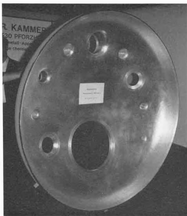
Abb. 3: Silberplattierter Deckel eines Rührkesselreaktors, Durchmesser 1800 mm, Firma Kammer, Pforzheim.
