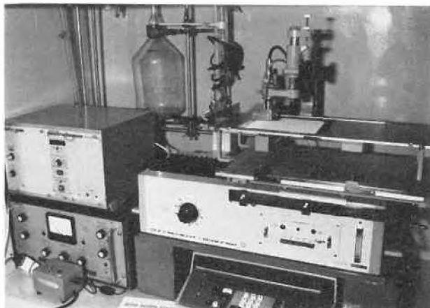
Abb. 2: Radio-Dünnschichtchromatographie. Auf dem oberen Tisch des beweglichen Wagens des Abtastgerätes wird eine Dünnschichtplatte mit einem Proportionalzählrohr laufend gemessen. Auf dem unteren Tisch des Wagens gibt eine Druckvorrichtung ein qualitatives Bild der Radioaktivitätsverteilung auf dem Chromatogramm. Zwischen den Stützklötzen, ein alter Rechner, der für die Ermittlung der zweckmässigen Abtastgeschwindigkeit beim Anlaufenlassen einer neuen Messung gute Dienste leistet. Links: oben die Steuer- und Zähllektronik, unten ein Zählratenmesser für die analoge Wiedergabe der Resultate bei stark indizierten Proben. Für die schwachen Präparate, die häufiger vorkommen, werden die Resultate über Lochstreifen, Rechner und digital gesteuertes Zeichengerät graphisch wiedergegeben. Die quantitative Auswertung erfolgt in allen Fällen numerisch.
