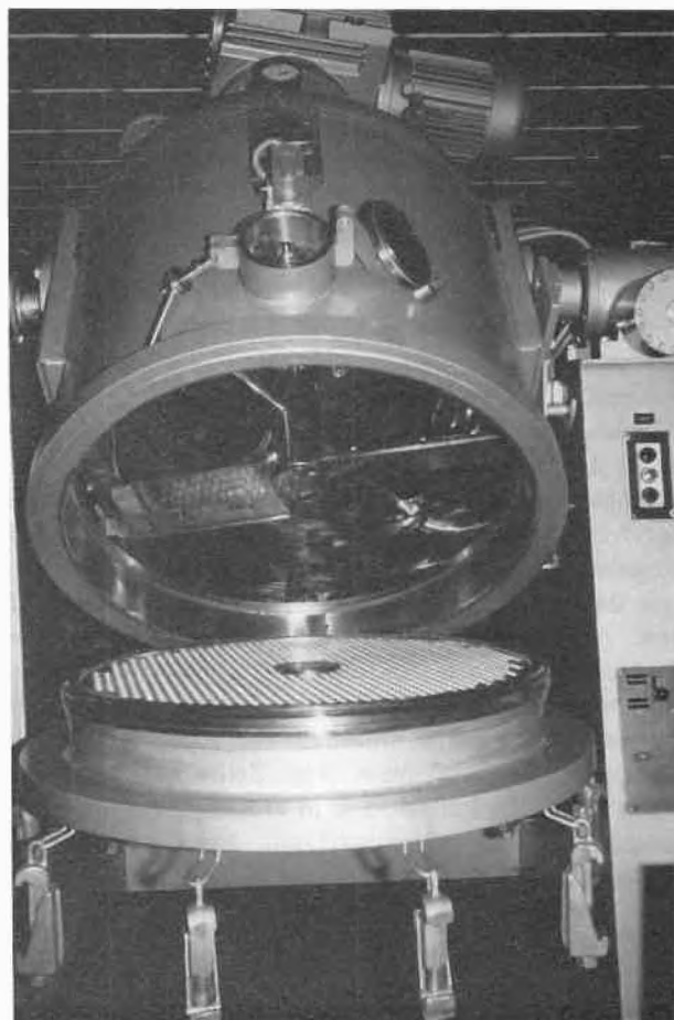
Abb. 10: Filtertrockner Firma SEITZ-Werke in geöffnetem Zustand: der Boden ist nach unten abklappbar, der ganze Apparat kann zudem um eine horizontale Achse gedreht werden.
