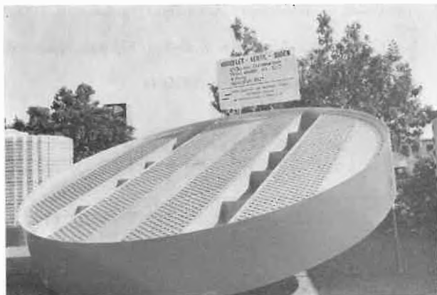
Abb. 1: In der Freilichtausstellung war dieser Boden einer Rektifikationskolonne der Firma STAHL-Apparate- und Gerätebau GmbH zu sehen. Durchmesser 6 m, Bestückung 1940 Varioflex-Ventile VV 12/2, 4-flütig, Werkstoff 4571.
