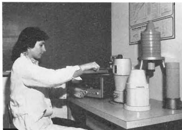
Abb. 3: Radiochemisches Praktikum, Elementarstufe. Einer der fünf zur Verfügung stehenden Messplätze. Man sieht neben dem Messgerät von links nach rechts folgende Detektoren: einen Flüssigszintillator-Detektor, ein Geiger-Müller-Zählrohrgehäuse für feste Präparate, eine Bohrlochkristall-Szintillations-Messsonde und das Gehäuse eines Geiger-Müller-Zählrohrs für flüssige Präparate.
