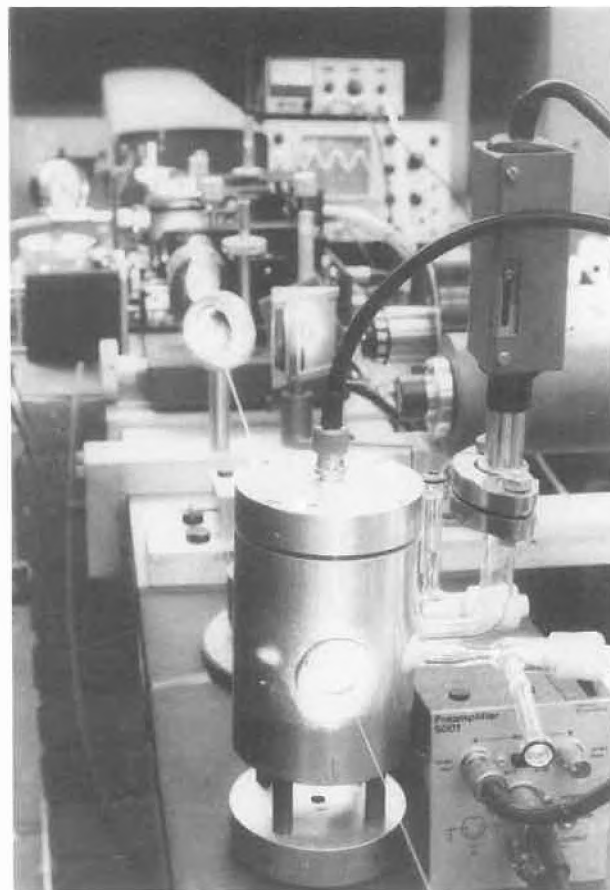
Fig. 1: Le laser ion-argon est utilisé pour créer des ondes sonores dans les gaz. En «écoutant» ces ondes sonores, les chercheurs de l'Université de Bristol sont capables de détecter et d'identifier rapidement des quantités infimes de gaz. Appelé «laser à détection opto-acoustique» (LOAD), cet instrument peut être utilisé pour la détection de gaz polluants dans l'atmosphère.
