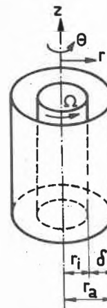
Abb. 1: Schematische Darstellung der Couette-Strömung im Ringraum zwischen innerem rotierendem und äusserem ruhendem Zylinder.
