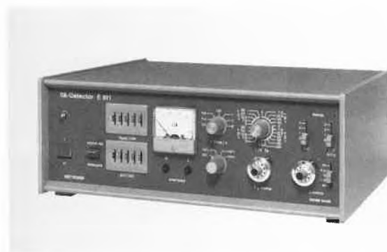
Abb. 9: VA-Detector E 611, das bei der elektrochemischen Detektion eingesetzte hochempfindliche Strommessgerät
