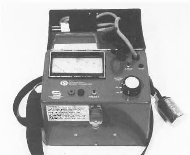
Abb. 2: Der I.S.T.-Detektor mit geöffnetem Deckel. Der Fühler (hier rechts auf dem Tisch liegend) ist über ein Kabel von maximal 120 m Länge an das Gerät angeschlossen. Man achte auf die nichtlineare Skala!
