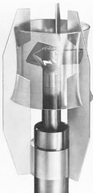
Mischkopf YXZET-Y, Statorgehäuse und Rotor
