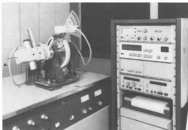
Abb. 8: Röntgendiffraktometer zur Quarzbestimmung
