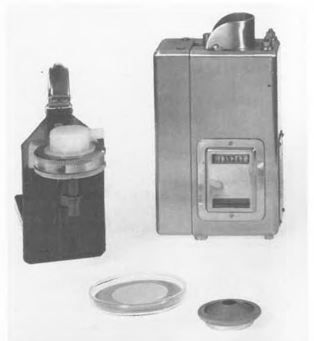
Abb. 5: Personnel Monitoring, Probenahmepumpe, Zyklon, Filter und Filterkassette
