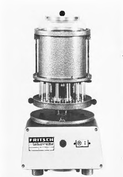
Abb. 4: elektromagnetischer Probenteiler «laborette 10» zum automatischen Teilen von Feststoffen. Maximale Korngrösse < 6 mm Kantenlänge, Füllvolumen 500 ml.
