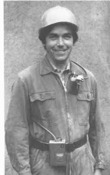
Abb. 4: Personnel Monitoring, Staubprobenahme «auf dem Mann»
