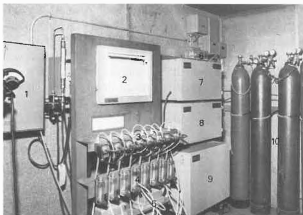
Abb. 5: Prozess-Gaschromatograph zur Messung von VCM. V.l.n.r.:
