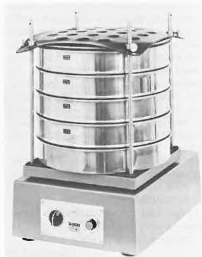
Abb. 1: Plansiebmaschine «analysette 18» für Siebe bis 400 mm/16" Durchmesser, auch verwendbar als Schütteltisch.
