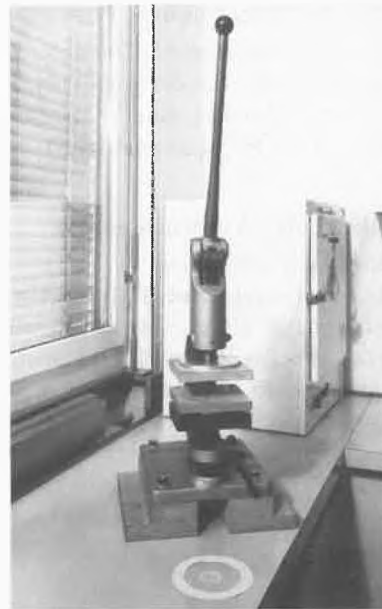
Abb. 7: Stanzapparat zum Ausstanzen des Feinstaubringes
