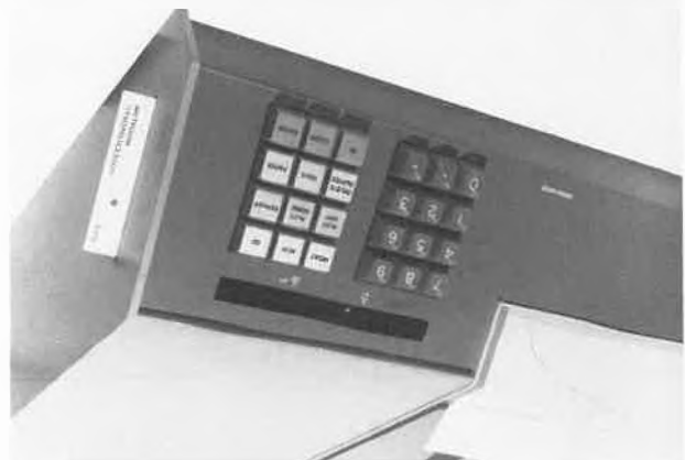
Abb. 4: Anzeige, Tastenfelder und eingeführte Steuerkarte des Titroprocessors E 636.
