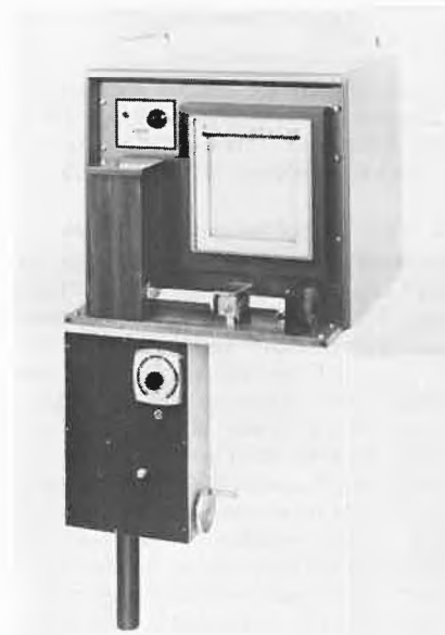
Abb. 9: Scanning-Photosedimentograph «analysette 20» mit eingebautem Schreiber, Messbereich 2 µm bis 100 µm
