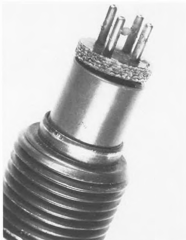
Abb. 3: Der Halbleiter-Sensor des I.S.T.-Detektors nach Entfernung der Schutzfritte: Die Sensor-Pille, Durchmesser 3–4 mm, ist an vier leitenden Drähtchen aufgehängt.
