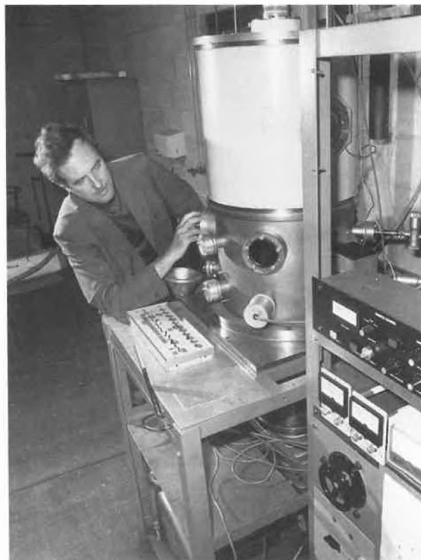
Abb. 1: Dr. Dennis Teer neben einer Ionenplattiermaschine in seinem Labor in der Maschinenbauabteilung der Universität Salford.
