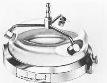
Abb. 5: Nass-Siebkopf mit 3 Düsen, passend für Siebe mit 200 mm/8" ø in Verbindung mit der «analysette 3».
