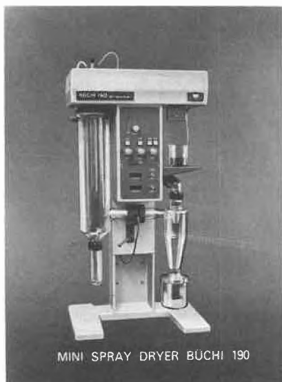
Abb. 6: Der Mini Spray Dryer 190 für die Laboranwendung wird für die Sprühtrocknung wie auch für die Strukturveränderung, Mikroinkapsulierung und Agglomeration in verschiedenen Bereichen der Chemie eingesetzt.
