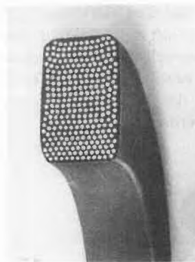
Abb. 14: Durchemailierte Spule (mit Giessharz imprägniert). Erste Fertigung 1947. (A. Imhof)
