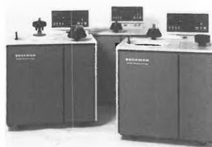
Abb. 4: Mikroprozessorgesteuerte präparative Ultrazentrifugen L-8
