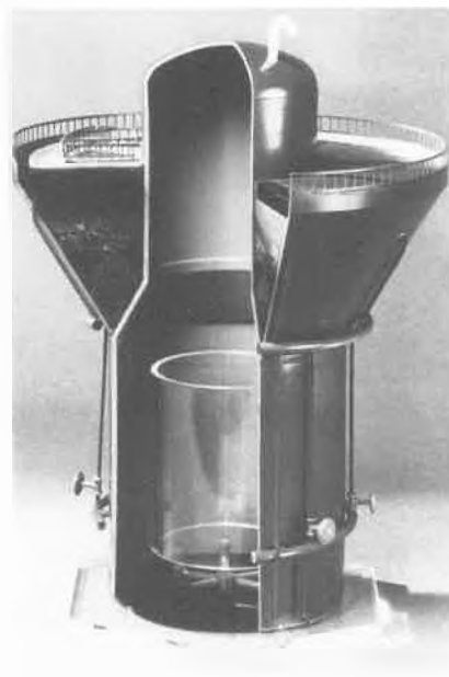
Abb. 4: Schnittmodell des Bio-Hochreaktors
