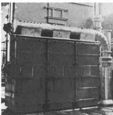
Spezial-Entstaubungsanlage, Typ AERSTAR, im Mahltrockenprozess für Farbstoffe. Ausführung in Sonderstahl, Druckstossfest mit Entlastungskappen, Geprüft VDI 3673
