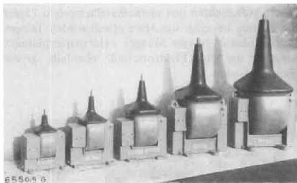
Abb. 15: Trocken-Spannungswandler für 10, 20, 30, 45 und 60 kV. Primärwicklung in Epoxidharz eingebettet (Imhof-Moser, Glaser & Co. AG.).
