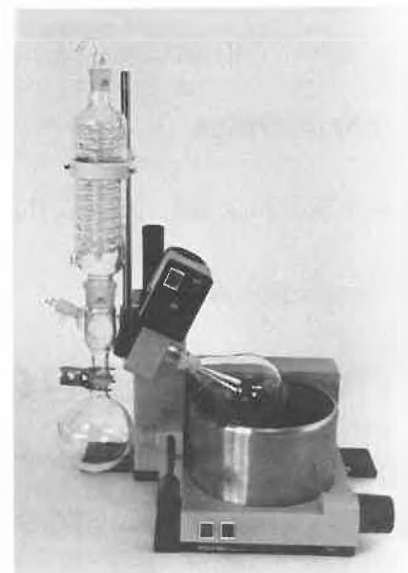
Abb. 5: Der Rotationsverdampfer dient für die schonende Destillation von Lösungsmitteln.
