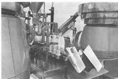
Abb. 3: Die fertige Rintal -Paste von Bayvet wird automatisch in Einwegspritzen abgefüllt.
