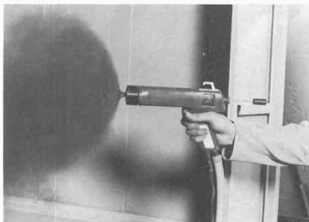
Abb.5: Spritzen mit elektrostatischer Pulverspritzpistole (Photo: Gema AG, St. Gallen)
