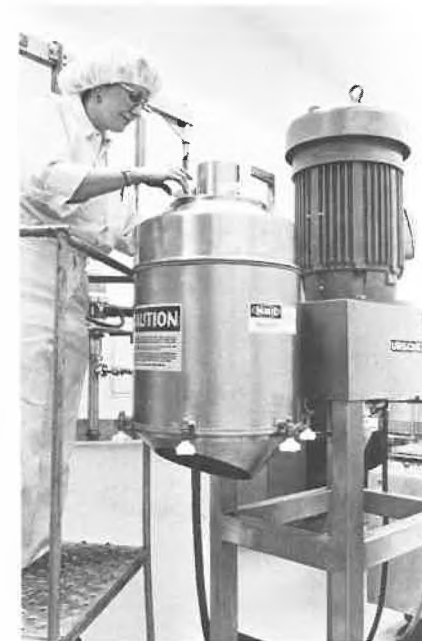
Abb. 1: In der Urschel Comitrol wird Zentrifugalkraft ausgenützt, um in einem Arbeitsgang zu deagglomerieren/homogenisieren.
