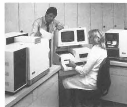
Abb. 3: Das Datensystem Vista 401 (Mitte) überwacht einen Vista 4600 Gaschromatographen und einen LC 5000 Flüssigchromatographen.
