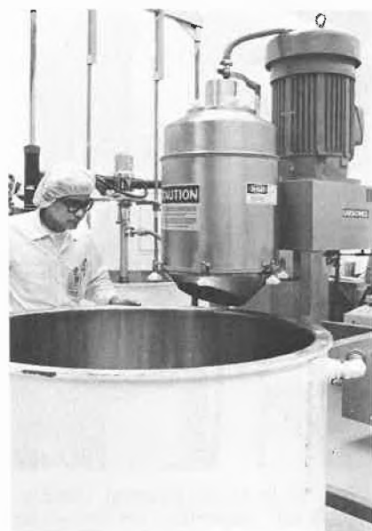
Abb. 2: Die Comitrol Zerkleinerungseinheit kann leicht gereinigt werden. Die Rostfreistahl-Sanitäre-Ausführung bietet Pharmazeuten wichtige Vorteile.
