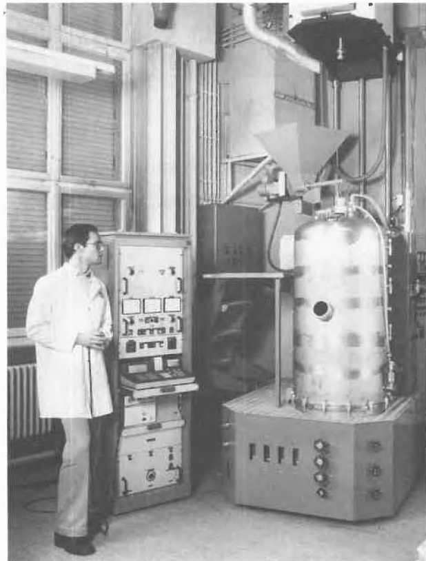
Abb. 2: Kristallzuchtanlage für GGG mit Steuerschrank (links) und wassergekühltem Ofenmantel. Die Füllrichtung (Trichter) ist eingeschwenkt zum Einfüllen der Oxide Gd_2O_3 und Ga_2O_3 .
