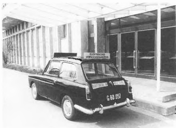
Abb. 6: Das Hybrid-Fahrzeug (Austin A-40), wie es jetzt in Graz an der Technischen Universität zum Erproben von verschiedenen Batteriekombinationen verwendet wird [10].
