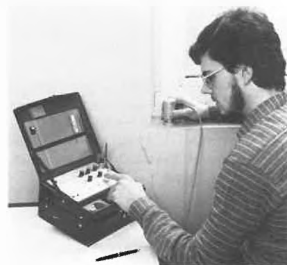
Das Bild zeigt das Schwingungsmessgerät SMU 31 im mobilen Einsatz.
