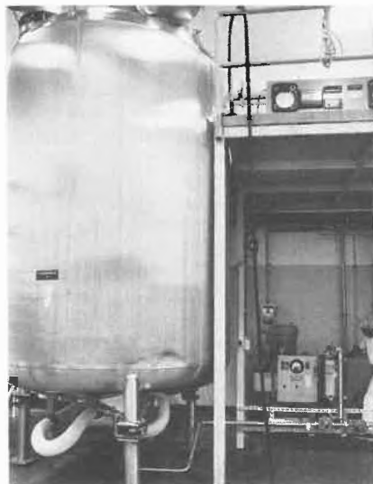
Abb. 3: Dieses Bild zeigt eine Produktionsanlage für Medikamente in Suspension für den oralen Gebrauch, wobei das Rezept in einem 10000 l Tank aufgeheizt und gemischt wird und mit einem Urschel Comitrol Modell 1700 dispergiert. Gegenüber einer vorher verwendeten Kolloidmühle konnte die Produktionszeit etwa halbiert werden.
