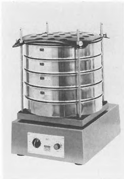
Abb. 1: «analysette-18» Plansiebmaschine/Schütteltisch für Analysensiebe bis 400 mm/16" Ø und zum Mischen von Flüssigkeiten und Suspensionen in Laborgläsern.
