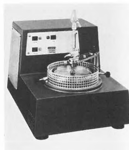
Abb. 6: Pipetten-Zentrifuge «analysette-21» zur Korngrößenanalyse im Bereich von 0,05 bis 5 \mu\text{m} in Suspension
