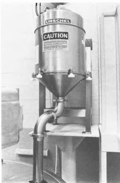
Abb. 2: Hier das Urschel Comitrol Modell 1700, welches mit 15 PS Motor für das Dispergieren der Salbe eine Rollenmühle mit 35 PS Antrieb ersetzte, und dabei fast den 4-fachen Ausstoss erbrachte.
