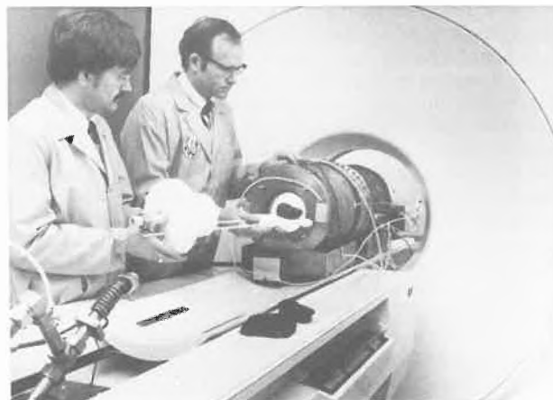
Abb. 1: Kohleproben werden in den Ofen eingeführt, der im Computertomografen die Stelle eines Patienten einnimmt. (Bild GE)
