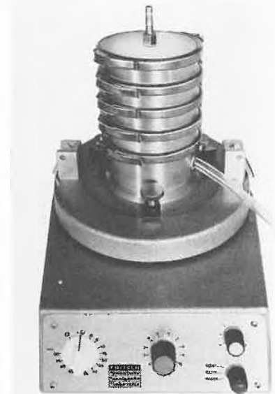
Abb. 4: «analysette-3» Nass-Siebung mit Mikro-Präzisionssieben
