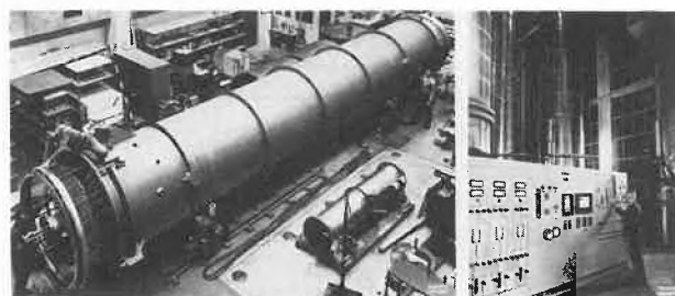
Abb. 27: a) Destillationskolonne, die auf dem Haarnadelgegenstromprinzip beruht b) Destillationsanlage, die auf Grund einer Idee von Werner Kuhn entwickelt wurde. Im Bau und in Funktion
