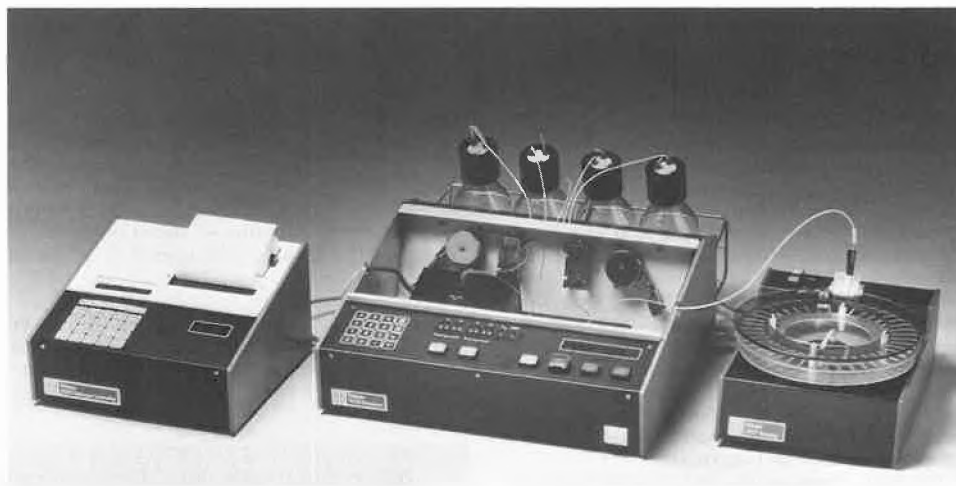
Fig. 2. FIAstar est un système compact intégré, piloté par microprocesseur. Il comprend (de gauche à droite) le module de contrôle du détecteur (équipé d'une imprimante graphique 4 couleurs) spectrophotomètre ou photomètre à filtre, l'analyseur et le passeur d'échantillons.
