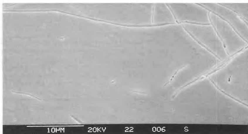
Fig. 13. Idem Fig. 1 mais la couche de IrO 2 -Ta 2 O 5 est déposée sur titane poli.
