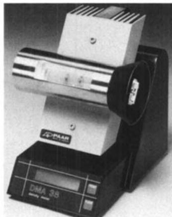
digitale Anzeige werden die absolute Dichte und eine beliebige andere (auch nichtlineare) dichtebezogene Grösse (kundenspezifische Programmierung) ausgegeben. Zwei Schnittstellen RS 232 C zum Anschluss an einen PC und/oder Drucker sind vorhanden. Der DMA-38 lässt sich von einem IBM-kompatiblen PC aus bedienen und ist das ideale Dichte- und Konzentrationsmessgerät zur Qualitätskontrolle in allen Industriebereichen, wo eine Genauigkeit von + 1 × 10<sup>-3</sup> g/cm<sup>3</sup> genügt.
