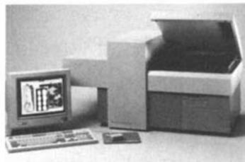
Die problemlose Wiederverwendbarkeit der Platten garantiert eine substanzielle Reduzierung der laufenden Kosten im Vergleich zu Filmen. Die applika-tionsorientierte ImageQuant-Software ist kompatibel mit diversen anderen Pro-grammen.
