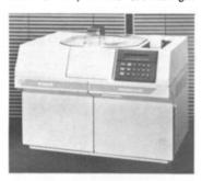
oder mit vier Kanälen für die Analyse von Na, K, Cl und CO<sub>2</sub> angeboten. Synchron EL-ISE enthält einen Probenteller für 40 Proben für Routine sowie Notfälle und bewältigt über 80 Elektrolytpanels pro Stunde. Der Betrieb ist entweder vollautomatisch oder manuell möglich. Als Probenvolumen werden nur 50 µl für Serum, Plasma oder CSF und 60 µl für Urin benötigt. Die arbeitssparende Software bietet viele Möglichkeiten.
