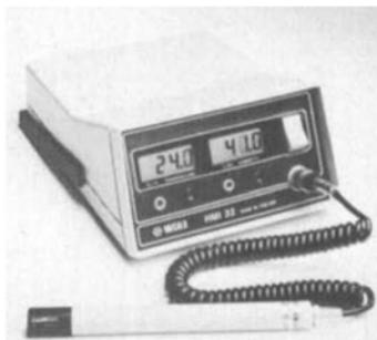
ausgerüstet, welcher als Polymerkondensator seine Kapazität in Abhängigkeit der Umgebungsfeuchtigkeit verändert. Die Temperatur wird mit einem PT-100-Widerstand gemessen. Für Servicezwecke gibt es ein breites Zubehörangebot, wie Eichnomale, Sinterfilter, Membranfilter und Taupunktschieber.
