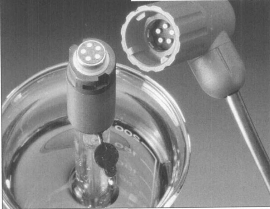
Speziell für genaue pH-Messungen in Proben mit unterschiedlichen Temperaturen, entwickelte INGOLD ein neues Elektrodenkonzept in Glas- und Kunststoffschicht-Ausführung für das Labor: die INGOLD InLab mit eingebautem Temperaturfühler und MultiPin Steckverbindung für einfachsten Elektrodenwechsel ohne Ersetzen des Verbindungskabels zu Ihrem pH-Meter.
