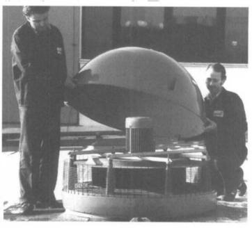
Haube und Sockel für die von der Mietzsch GmbH Lufttechnik, Dresden, hergestellten Radialdachventilatoren bestehen aus \*Baydur 40, einem neuen, FCKW-freien Polyurethan-System aus Rohstoffen der Bayer AG. Die Bauteile sind dauerhaft beständig gegen Witterungseinflüsse und Korrosion.
