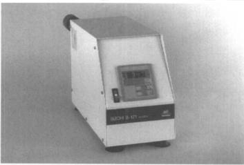
Der Einsatz von kontrolliertem Vakuum, im Bereich von Atmosphärendruck bis 10 mbar, lässt sich aus dem modernen Laboralltag nicht mehr wegdenken. Zusammen mit Anwendern wurde die VACOBOX B-171 entwickelt. Die VACOBOX B-171 verbindet einen vollelektronischen Vakuum-Controller mit einer leistungsstarken und chemikalienbeständigen Teflonmembranpumpe.
