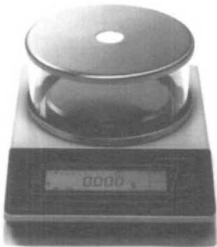
puter mit dem superschnellen 40 MHz-Takt ist. Daraus ergeben sich ausserordentlich kurze Messzeiten sowie ein noch wirksameres Ausfiltern von Vibrationen. Unter allen Beleuchtungsverhältnissen wird die denkbar beste Ablesbarkeit erreicht, und die Waagen lassen sich gut an
