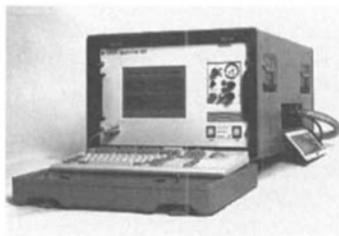
stem. Das Betriebssystem Spectra Scan\OS arbeitet unter Windows 3.0. Neben den für den Betrieb des Gerätes notwendigen Funktionen enthält dieses auch eine Massenspektren-Bibliothek mit über 50 000 Spektren.
