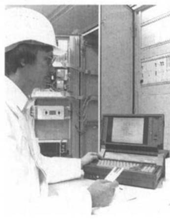
Basic-Software (Basic-Kit) besteht. Über die Schnittstellen-Karte wird das Programmiergerät an die entsprechende Master-Station angekoppelt.
