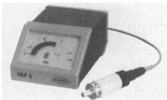
Mit dem neuen Pirani-Messgerät VAP 5 hat VACCUBRAND dem aktuellen Gesundheits- und Umweltbewusstsein im Labor Rechnung getragen und ein Messgerät entwickelt, das im Feinvakuumbereich die Quecksilbermessgeräte ersetzen wird.
