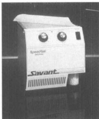
Der SPEEDGEL SG100 eignet sich sowohl für Trocknung von Acrylamid – wie Agarose-Gelen.
