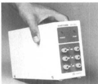
Effektives Entgasen der mobilen Phase in der Flüssigchromatographie verhindert nicht nur die Bildung von Gasblasen während Gradiententrennungen im Chromatographiesystem, sondern verbessert auch die Basislinienstabilität, das Signal-Rausch-Verhältnis, die Nachweisempfindlichkeit, insbesondere bei UV-, Fluoreszenz-, Brechungsindex- und elektrochemischer Detektion.
