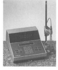
Puffer von Metrohm, DIN, NIST (NBS), Ingold, Merck, Riedel-de Haën, Fisher, Radiometer, Beckman, Ciba oder auch Spezialpuffer werden automatisch erkannt. Mit Pt100 oder Pt1000-Temperaturfühlern erübrigt sich die manuelle Eingabe der Temperatur.
