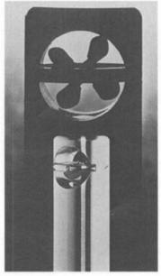
Die Baureihe hochtemperaturbeständiger Flügelradmesswertaufnehmer für die Strömungs-/Volumenmessung von Luft/Gasen wurde um eine weitere Ausführung für Dauerbetriebstemperaturen bis 550° ergänzt.
