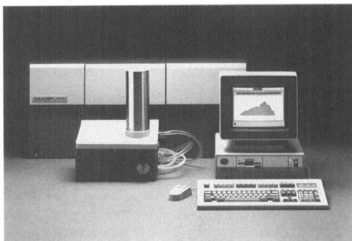
Schnell aufeinanderfolgende Neuentwicklungen von Produkten mit feinsten Partikeln erfordern eine flexible und verlässliche Messtechnik zur Bestimmung der Grössenverteilung. Für die Partikelgrössenanalyse in Flüssigkeiten, insbesondere im Submikronbereich, hat sich das Prinzip der Laserbeugung inzwischen gut eingeführt. Es beruht auf der Eigenschaft von Partikeln, polarisiertes Licht abhängig von ihrer Grösse, unterschiedlich stark zu streuen.
