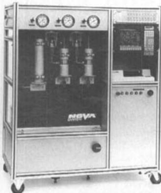
Hochdruck-Extraktion (HDE) wird als energiesparende und umweltfreundliche Alternative zur Destillation und/oder flüssig Extraktion immer mehr angewendet. Die durch HDE gewonnenen Produkte sind frei von Lösungsmittel-Rückständen. Mittels HDE können auch temperaturempfindliche Substanzen behandelt ohne zerstört zu werden.
