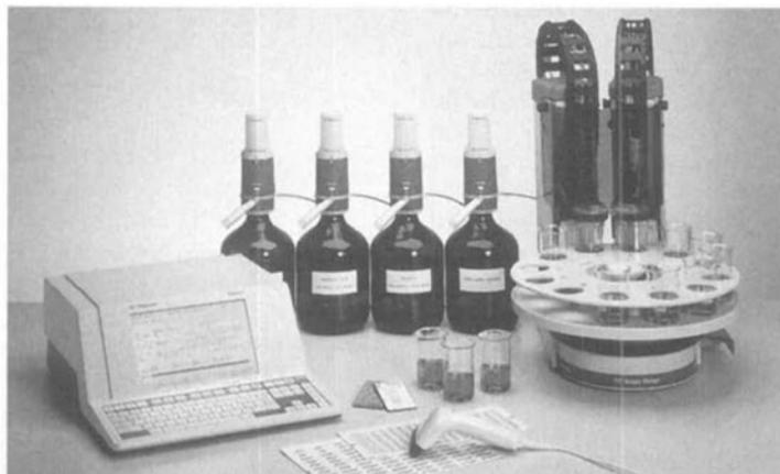
Der GP-Titrino 736 das Flaggschiff der Titrino-Familie ist ein kompakter Titrator der Extraklasse. Neben der dynamischen und monotonen Äquivalenzpunkt-Titration beherrscht er auch die Endpunkt-Titration, pH-STAT-Anwendungen sowie die Karl-Fischer-Titration. Er misst zudem pH-, mV- und °C-Werte und dosiert unter Überwachung von
